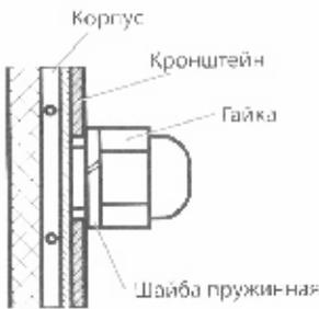
Рис. 3а. Крепление кронштейнов к корпусу
